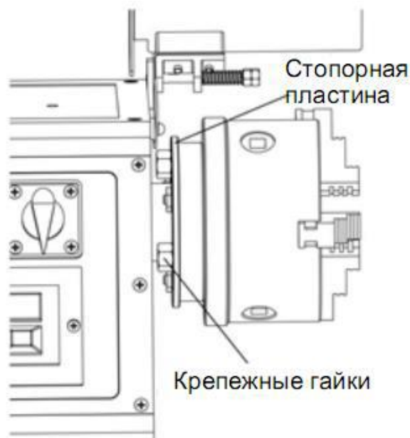
Рис. 5 Компоненты торца шпинделя
