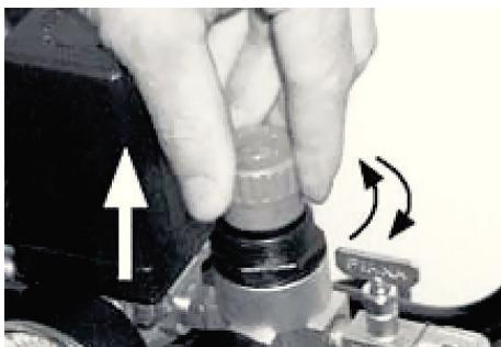
■ Получив оптимальное для работы давление, заблокируйте клапан в нужном положении. Для блокировки следует вращать стопорное кольцо, под регулировочной ручкой до ее полной блокировки.
