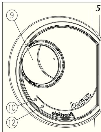
Водонагреватель автоматически включается при уровне протока воды выше 2,5 л/мин. В зависимости от величины забора воды и установки переключателем на корпусе водонагревателя требуемой температуры воды, система управления подбирает соответствующую мощность нагрева. На корпусе водонагревателя находятся индикаторы, сигнализирующие о: включении водонагревателя в электрическую сеть - зеленый, включении нагрева - красный.
