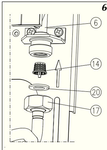
С целью обеспечения правильной и длительной эксплуатации водонагревателя следует периодически производить очистку фильтра воды [14], которую потребитель должен осуществлять самостоятельно (гарантии не подлежат). Для осуществления очистки фильтра следует (рис.6):
