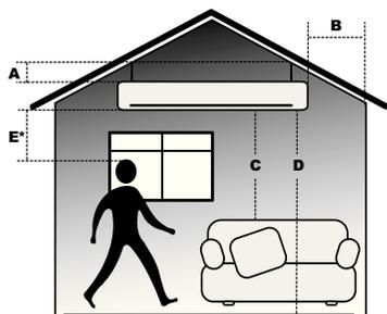
Правила установки инфракрасного обогревателя BALLU (минимальные расстояния от прибора до поверхностей).
