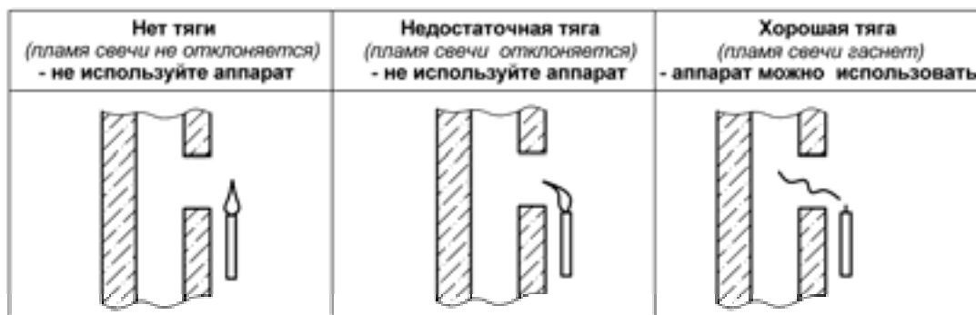
Рисунок 4. Способ проверки тяги в дымоходе
