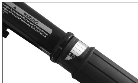
Рис.3 Рукоятка управления дросельной заслонкой
