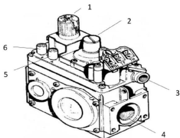
Рисунок 10 – Внешний вид газового клапана
