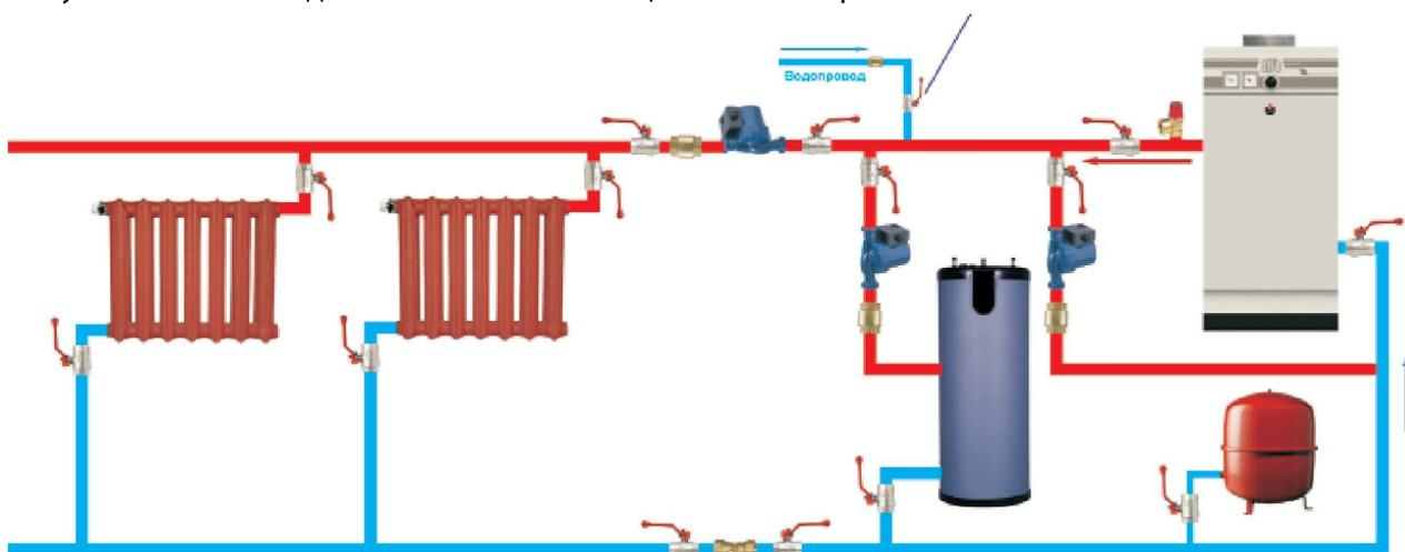
Рисунок 7. Схема подключения котла с принудительной циркуляцией теплоносителя.
