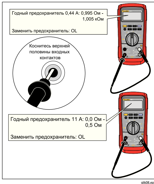
Рис. 10. Проверка предохранителей
