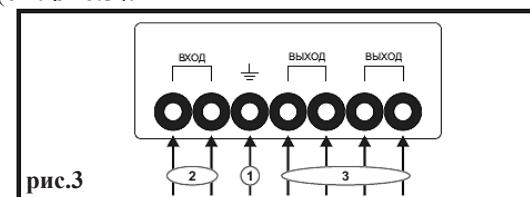
выход 1 - для подключения заземления
