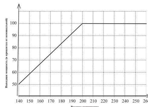
Как видно на графике при входном напряжении ниже 200 В мощность стабилизатора уменьшается.
