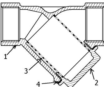
Фильтр состоит из корпуса 1, пробки 2, фильтроэлемента 3 и прокладки 4. Корпус и пробка фильтров диаметром условного прохода до 2" выполнены из горячепрессованной, никелированной латуни марки CW617N. Между пробкой и корпусом располагается уплотнительная прокладка из тefлона. В корпус помещен фильтроэлемент из нержавеющей стали AISI 316 (толщина проволоки 0,3мм). Пробка фильтра имеет отверстие (ушко) для пломбировки. Направление потока указано стрелкой на корпусе фильтра.
