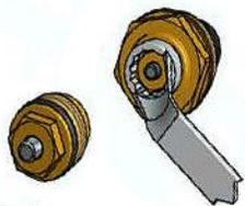
6.5. При течи из-под штока термостатического клапана, головка клапана может быть снята, отремонтирована или заменена. Головка отвинчивается с помощью гаечного ключа. Слить воду из коллектора при этом не нужно.
