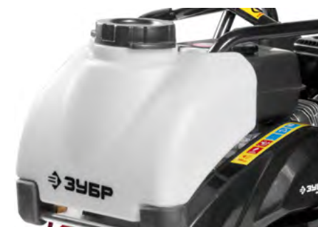
Наличие системы орошения – обязательное условие при уплотнении асфальтобетонных смесей
