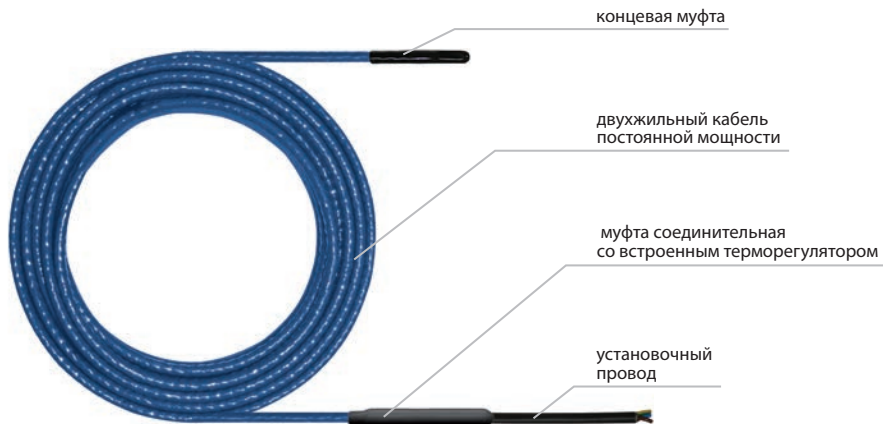
Рис. 1. Конструкция нагревательной секции
