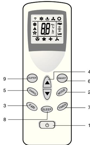
1. Кнопка включения/выключения прибора.
