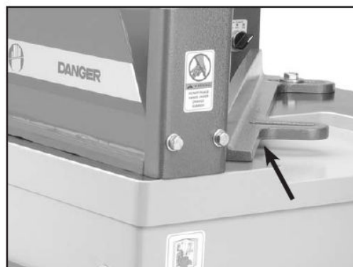
Рис. 13. Опорная линейка в транспортировочном положении.
