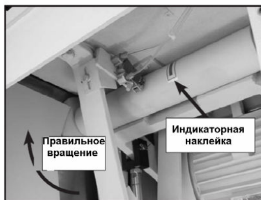
Рис. 30. Определение правильного направления вращения пилы станка.
