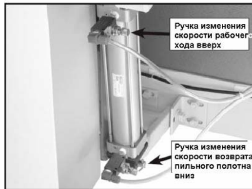
Рис. 33. Пневматический цилиндр и клапаны регулировки рабочего хода.
