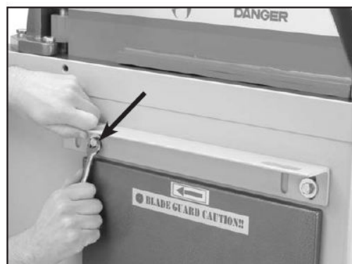
Рис. 9. Крепление одной из установочных скоб к станине станка.
