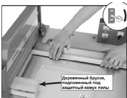
Рис. 49. Установка опорной линейки перпендикулярно пыльному полотну.
