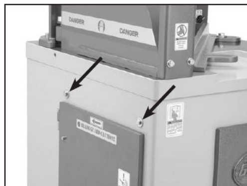
Рис. 8. Снимаемые болты крепления рольганга.
