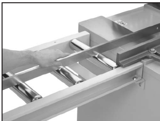
Рис. 18. Использование образцовой линейки для выставки плоскости рольганга относительно плоскости рабочего стола
