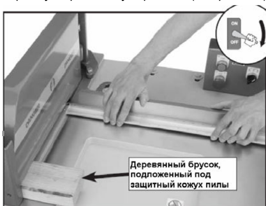
Рис. 49. Установка опорной линейки перпендикулярно пильному полотну.
