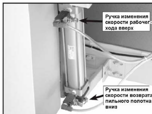
Рис. 33. Пневматический цилиндр и клапаны регулировки рабочего хода.
