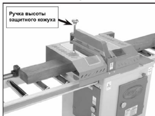
Рис. 31. Обрабатываемый элемент, подготовленный для распила.
