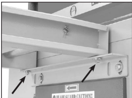
Рис. 12. Рольганг, закрепленный на установочной скобе.
