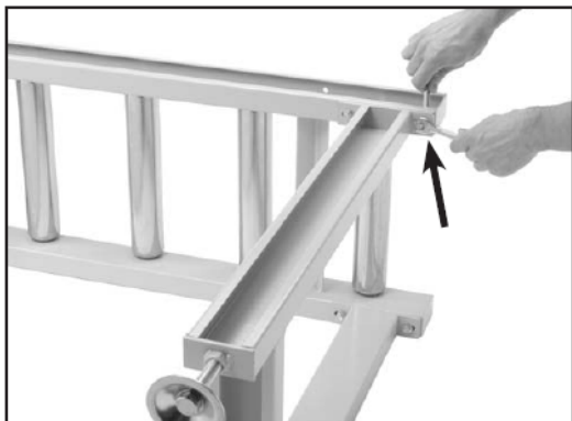
Рис. 11. Крепление опорной группы к рольгангу.
