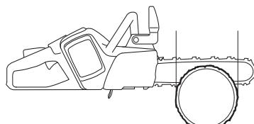
Существуют методы валки деревьев с полотном, меньшим диаметром ствола. Однако эти методы достаточно опасны, т.к. область отдачи полотна входит в контакт с предметом.
