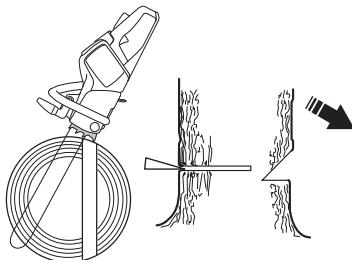
Закончить основной пропил нужно параллельно линии направляющего пропила так, чтобы расстояние между ними составляло около 1/10 диаметра ствола. Нераспиленный участок ствола называется полоса разлома (недопил). Полоса разлома действует как петельный щарнир, задающий направление падения дерева.
