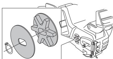
Следует регулярно проверять степень износа звездочки привода. Заменять при сильном износе.
