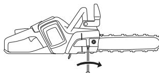
Цепь считается натянутой правильно, если она не провисает снизу и если ее можно проворачивать рукой. Затяните гайки на шине пилы универсальным ключом, удерживайте при этом носок шины пилы рукой.
