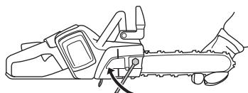
При установке новой цепи следует часто проверять ее натяжение, пока цепь не приработается. Регулярно проверяйте натяжение цепи. Регулярно проверяйте натяжение цепи. Правильно натянутая цепь обеспечивает высокое качество пиления и дольше служит.
