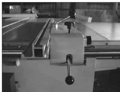
На этом рисунке показана алюминиевая линейка в положении для угловых распилов.
