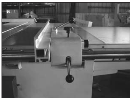
На этом рисунке показана алюминиевая линейка в положении 90°.
