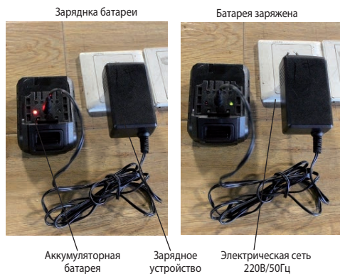
Рис. 2. Зарядка аккумуляторной батареи
