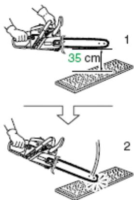
Механический (не ручной) тормоз цепи останавливает работу пильной цепи таким образом, что эффект обратного удара, возникающий в наконечнике/носке пильной шины автоматически включает тормоз цепи.
