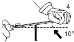
Когда заточка пильной цепи завершена, замочите ее в масле и смойте с нее все металлические опилки до начала эксплуатации.
