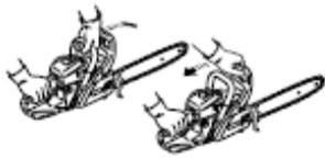
1. Заблокируйте цепь – нажмите вперед передний защитный щиток. Чтобы повернуть цепь, отожмите передний защитный щиток, прижав его к передней ручке пилы.
