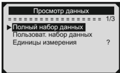
Просмотр текущих PID данных на экране. Используйте кнопки ВВЕРХ / ВНИЗ для переключения экранов, если вся информация не помещается на одном экране.
