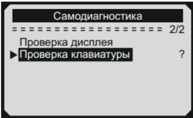
Нажмите любую кнопку чтобы начать тест. При нажатии кнопки, на дисплее должно отображаться ее название.
