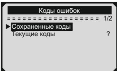
При отсутствии в настоящее время диагностических кодов неисправностей, на дисплее отображается “No (pending) codes are stored in the module!” (Нет текущих кодов хранящихся в модуле) Подождите несколько секунд или нажмите любую клавишу для возврата в меню диагностики.
