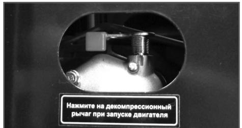
Рис. 14 Рычаг декомпрессора
