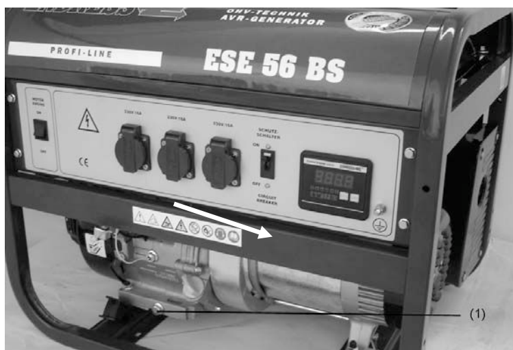
Рис. 4.4: Удаление винта для слива масла
