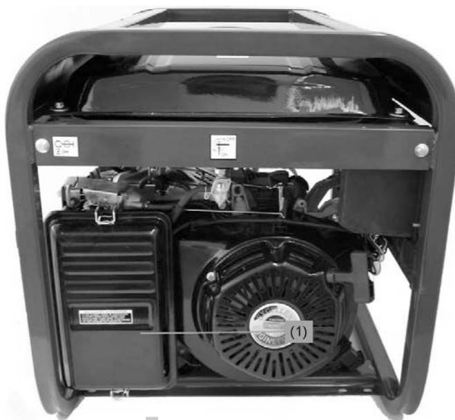
Рис. 4.7: Снятие воздушного фильтра
