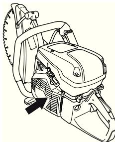
**ПРЕДУПРЕЖДЕНИЕ!** Загрязненный или закрытый воздухозаборник может привести к перегреву машины и вызвать повреждение поршня и цилиндра.
