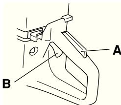
Замок триггера остается нажатым до тех пор, пока нажат дроссель. Когда вы отпускаете рукоятку, то ручка газа и фиксатор ручки газа возвращаются в свое первоначальное положение. Это осуществляется благодаря двум независимым друг от друга системам пружин. В таком положении ручка газа автоматически фиксируется на холостых оборотах.
