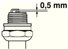
**ПРЕДУПРЕЖДЕНИЕ!** Всегда используйте только указанный тип свечи! Применение несоответствующей модели может привести к серьезным повреждениям поршня/цилиндра.
