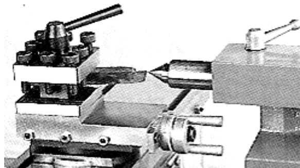
Рис 8-5 Крепление резца
