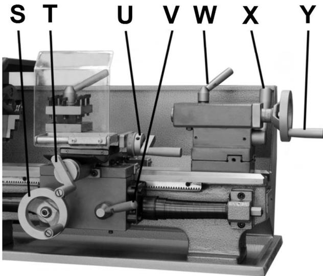
Рис 8-6 Рычаги станка
