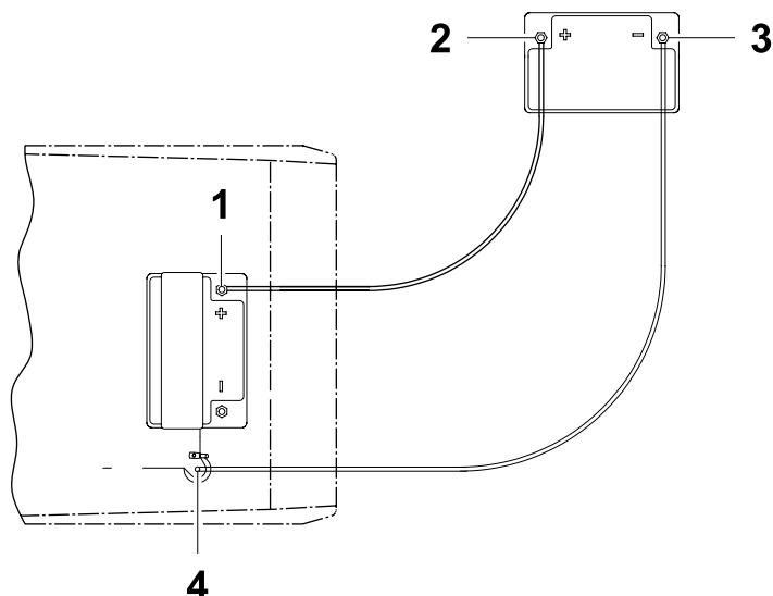
При запуске с использованием посторонней аккумуляторной батареи следует соблюдать следующую очередь при подсоединении:
