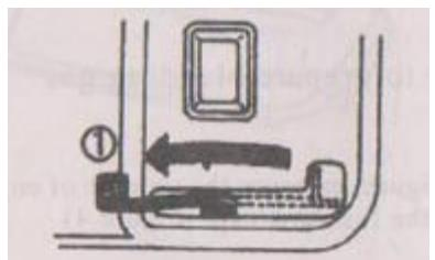
5. Переключите выключатель генератора в положение «ON» / «ВКЛ».
