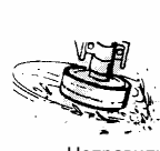
Неправильно – Струна полностью введена на место выполнения стрижки.
