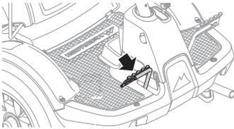
Тормоз и сцепление включаются при нажатии на педаль до упора. Педаль сцепления отключает двигатель и останавливает привод на колеса. Педаль сцепления не действует на привод ножей.
