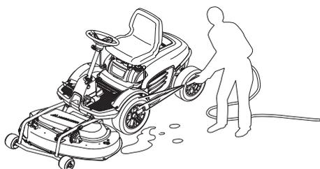
Масляные загрязнения могут быть сняты холодным обезжиривателем. Распылите тонкий слой.
