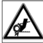
Перед выполнением ремонта или технического обслуживания остановите двигатель и отсоедините провод зажигания
