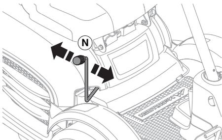
Поднимите и потяните рычаг назад для включения заднего хода.
