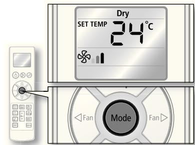
Каждый раз вы нажмите кнопку **Mode**, режим будет изменен в следующие типы: Auto (Авто), Cool (Охлаждение), Dry (Влагопоглощение), Fan (Вентилятор) и Heat (Обогрев).
