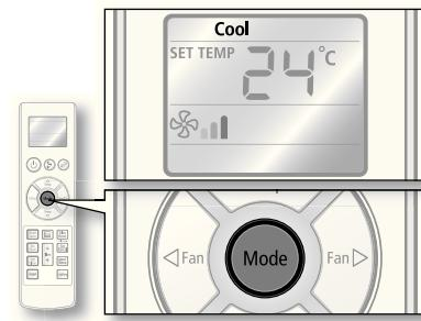
Каждый раз вы нажмите кнопку **Mode**, режим будет изменен в следующие типы: Auto (Авто), Cool (Охлаждение), Dry (Влагопоглощение), Fan (Вентилятор) и Heat (Обогрев).
