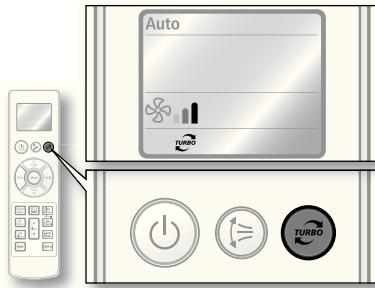
Функция «Turbo» доступна только в режимах «Auto»(Автом.), «Cool»(Охлаждение) и «Heat»(Обогрев). Если включить функцию «Turbo» в режиме «Dry»(Осушение)/«Fan»(Вентилятор), произойдет переключение в кондиционера в режим «Auto»(Автом.).
