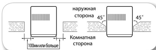
Если толщина стены в более 150мм, сократите заднюю часть стены в 45°.
