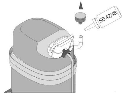
Ваш компрессор поставляется не заполненный маслом для безопасной транспортировки. Перед началом использования необходимо заполнить отсек масляного фильтра маслом до нужного уровня.
