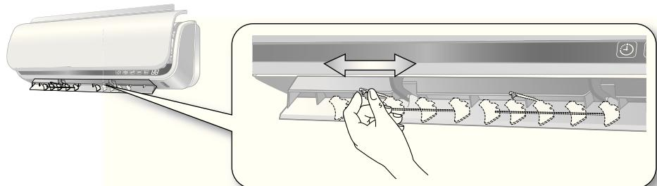
**ОСТОРОЖНО** Будьте осторожны регулируя горизонтальное направление воздушного потока. Потенциальный риск телесных повреждений при неправильном обращении с прибором.
