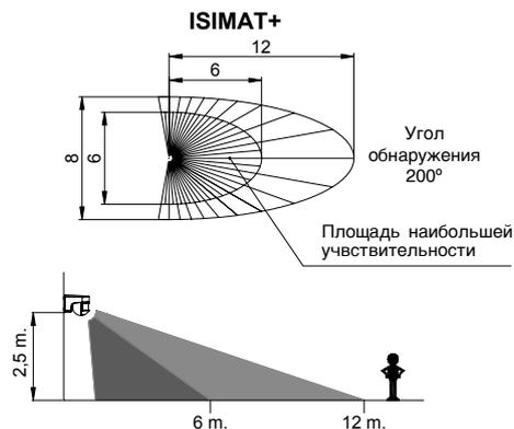
При установке датчика ISIMAT+ должны принять во внимание, что обнаружение производится пересечением (кроссированием) лучей обнаружения и поэтому, если объект будет двигаться параллельно по отношению к лучам, то будет засечен на более близком расстоянии, так как он не пересекает лучи.
