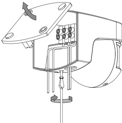
Установите основу в место, где будет закреплен прибор. Идеальная установка датчика на высоте между двумя и тремя метрами вдали от возможных источников температуры.
