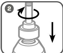
Закрутите ступенчатую шпильку в поршень. На шпильку установите опорную втулку
