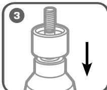
Поверх опорной втулки установите матрицу с маркировкой из вышеперечисленного ряда
