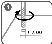
Просверлите в листе направляющее отверстие диаметром 11 мм
