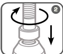
Закрутите шпильку диаметром 20 мм в поршень. На шпильку установите опорную втулку
