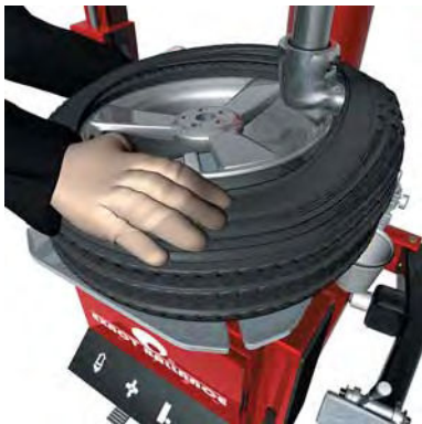
Рисунок 6 – Установка шины на обод
