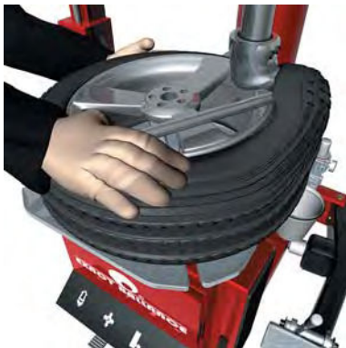
Рисунок 5 – Снятие шины с диска
