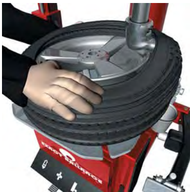
Рисунок 6 – Установка шины на обод
