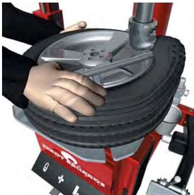
Рисунок 5 – Снятие шины с диска
