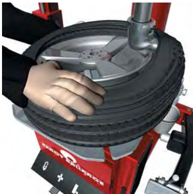
Рисунок 6 – Установка шины на обод
