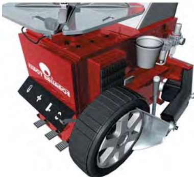
Рисунок 4 – Отжим шины от диска
