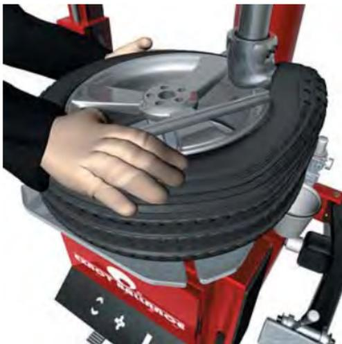
Рисунок 5 – Снятие шины с диска
