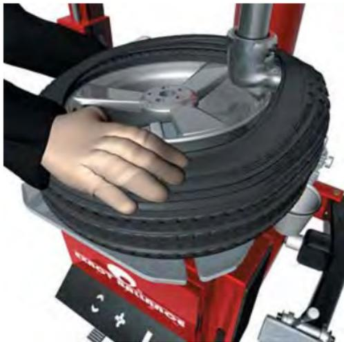
Рисунок 6 – Установка шины на обод
