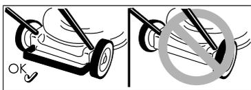
Опасность травмирования – работать только с установленной скобой безопасности.
