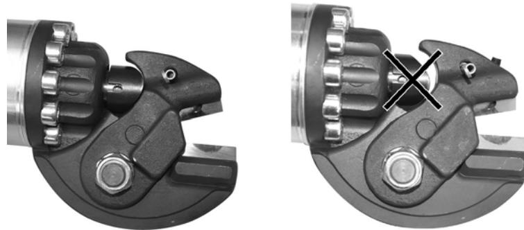
4. Установить наконечник толкателя на толкатель и выставить его так, чтобы наконечник толкателя входил в закругление верхнего держателя ножа.
