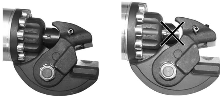
1. Установить наконечник толкателя на толкатель и выставить его так, чтобы наконечник толкателя входил в закругление верхнего держателя ножа.
