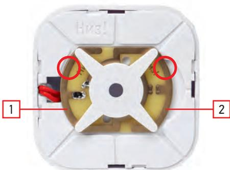
Замыкание контактов 1 и 2 для прописки датчиков
