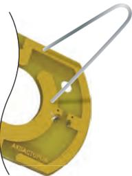
Перед монтажом радиодатчика необходимо протестировать реакцию системы на его залив. Для имитации залива необходимо замкнуть и удерживать позолоченные контакты на контактной пластине радиодатчика металлическим предметом (например, скрепкой или пинцетом).
