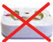
❌ **НЕ ДОПУСКАЕТСЯ** установка радиодатчика контактной пластиной вверх, т.к. это делает невозможным обнаружение залива (кроме прямого попадания брызг сверху), а также резко ухудшает работу антенны радиодатчика.
