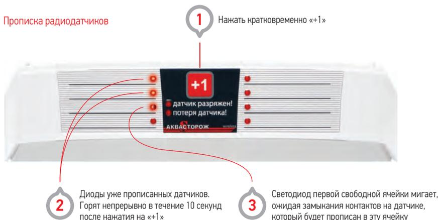
2. В течение 10 секунд после нажатия на «+1» необходимо замкнуть и удерживать позолоченные контакты на пластине радиодатчика металлическим предметом, например, скрепкой или пинцетом (см. рисунок).
