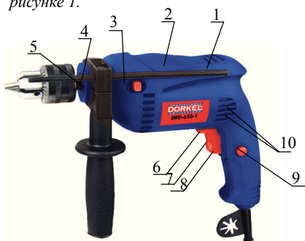
1-корпус; 2-переключатель режимов (сверление, сверление с перфорацией); 3-рукоятка дополнительная; 4-патрон сверлильный; 5-ограничитель глубины сверления; 6-переключатель направления вращения (реверс); 7-регулятор скорости; 8-клавиша выключателя; 9-кнопка фиксации клавиши выключателя; 10-вентиляционные каналы;
