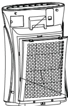
Снимите решетку воздухозаборника и фильтр предварительной очистки
