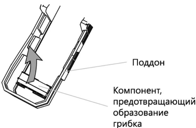
Техническое обслуживание фильтра, предотвращающего образование грибка
