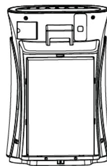
Снимите фильтр тонкой очистки (HEPA) и дезодорирующий фильтр
