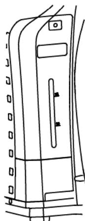
Осторожно защелкните верхний фиксатор, чтобы гарантировать, что резервуар для воды установлен правильно.
