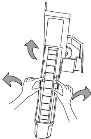
Выдвиньте поддержку поддона для воды двумя большими пальцами и вытолкните колесо из поддона.
