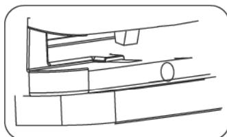
Сначала вставьте нижнюю часть решетки воздухозаборника, затем верхнюю часть и слегка нажмите кнопку верхнего фиксатора.
