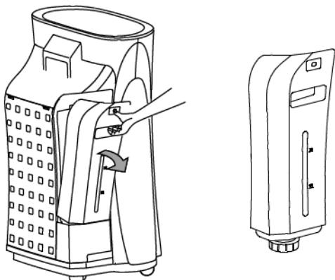
Техническое обслуживание резервуара для воды (каждый раз добавляя воду):
