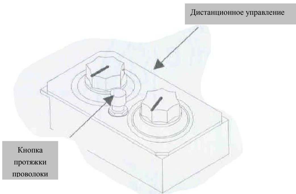
\*Нажмите кнопку протяжки проволоки на подающем механизме. Начните подачу проволоки после выравнивания горелки. Отпустите кнопку передвижения, когда проволока покажется на 10 мм из контактного наконечника.
