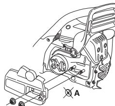
Установите пильное полотно на специально предназначенные болты. Установите полотно в самое заднее положение. Оденьте цепь на ведущую звездочку и вставьте ее хвостовики в паз пильного полотна. Начнайте с верхней стороны пильного полотна.
