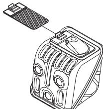
Глушитель служит для снижения уровня шума и отвода раскаленных выхлопных газов от рабочего. Выхлопные газы очень горячие и могут содержать искры, что может привести к пожару при прямом попадании на сухой и воспламеняющийся материал.
