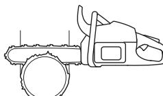
Существуют методы валки деревьев с полотном, меньшим диаметра ствола. Однако эти методы достаточно опасны, т.к. область отдачи полотна входит в контакт с предметом.
