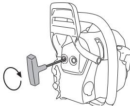
В некоторых глушителях предусмотрен специальный искрогаситель. Если ваша машина оборудована таким глушителем, сетку фильтра следует чистить раз в неделю. Наилучше пользоваться стальной щеткой. Забитая решетка приводит к работе с горячим двигателем, что дает серьезные повреждения двигателя.
