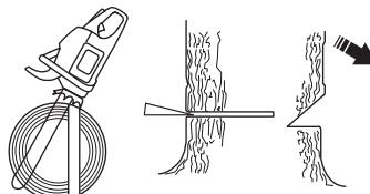
Закончить основной пропил нужно параллельно линии направляющего пропила так, чтобы расстояние между ними составляло около 1/10 диаметра ствола. Нераспиленный участок ствола называется полоса разлома (недопил). Полоса разлома действует как петельный щарнир, задающий направление падения дерева.
