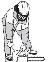
Твердо возмите моторную пилу, обхватив ручки всей ладонью.
