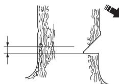
Вставьте зубчатый упор (если установлен) сзади надреза. Работайте на полном газу и вводите пильное полотно в ствол дерева постепенно, плавным движением. Следите за тем, чтобы дерево не начало перемещаться в направлении, противоположном предполагаемому направлению падения. Как только пропил станет достаточно глубоким, загоните в него клин или вагу.
