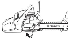
При установки новой цепи следует часто проверять ее натяжение , пока цепь не приработается. Регулярно проверяйте натяжение цепи. Регулярно проверяйте натяжение цепи. Правильно натянутая цепь обеспечивает высокое качество пиления и дольше служит.
