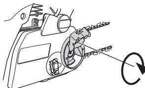
При установке новой цепи следует часто проверять ее натяжение, пока цепь не приработается. Регулярно проверяйте натяжение цепи. Регулярно проверяйте натяжение цепи. Правильно натянутая цепь обеспечивает высокое качество пиления и дольше служит.
