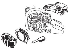
Производите очистку системы охлаждения щеткой раз в неделю или чаще, если этого требуют условия работы. Загрязненная или засоренная система охлаждения может привести к перегреву машины и вызвать повреждение поршня и цилиндра.
