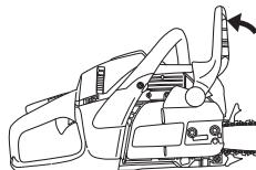
Отвинтите гайки крепления пильного полотна и снимите крышку муфты сцепления (тормоза цепи). Снимите транспортировочное кольцо (A).
