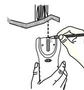
**3) Определение местонахождения электрических кабелей под напряжением:**
