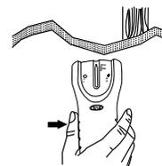
**2) Определение местонахождения древесины и металла:**
