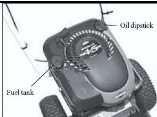
1. Топливный и масляный бак (двигатель V&S)
