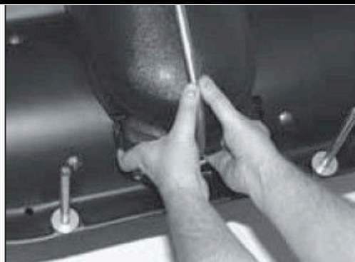
2. Переднее положение при подъеме машины. ПРЕДОСТЕРЕЖЕНИЕ! Опасность раны! При переносе держите место с рулем вашим большим пальцем.
