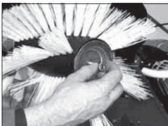
9. Теперь установите втулки на место при помощи контргаяк.
