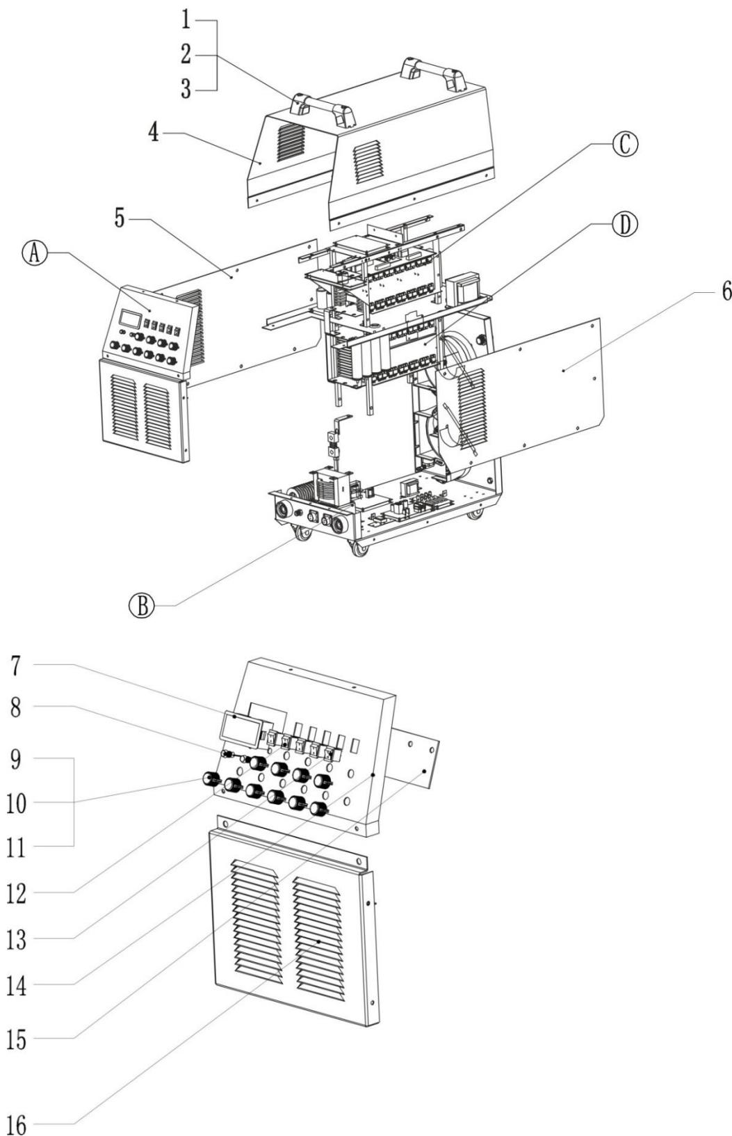
Взрыв-схема TIG-315BP AC/DC
